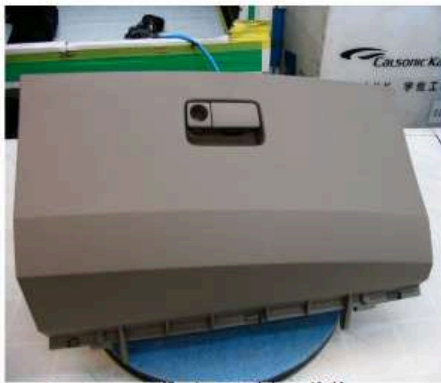
▲ コンソールボックスの外部の塗装
