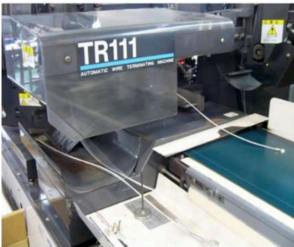
▲ ワイヤを必要な長さに自動でカットして端子をつける装置
