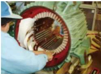
発電機・モーター点検・整備
