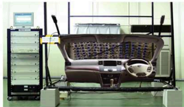
▲風速計測システム
