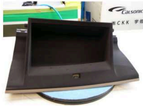
▲ コンソールボックスの内部の塗装
