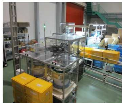
半自動機による組立て作業
