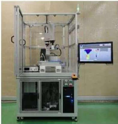
▲ベクトル磁気特性可視化装置
