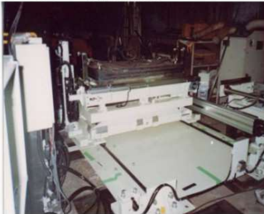
▲ 液晶パネル・ガラス搬送装置
