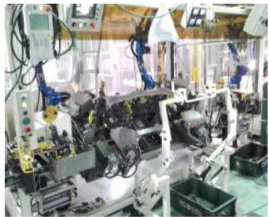
▲ アークロボット溶接装置
