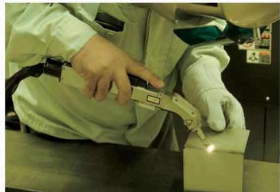
▲ ファイバーレーザー溶接機
