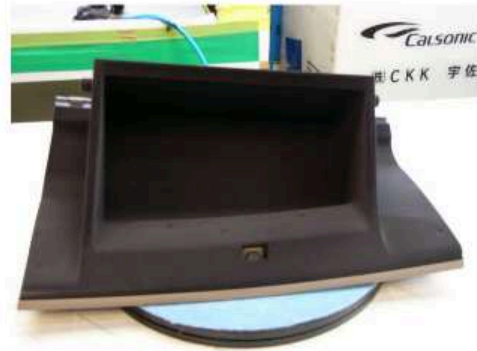
▲ コンソールボックスの内部の塗装
