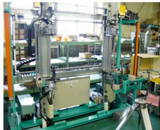
▲ アルミサッシの成形機
