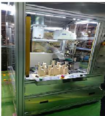
▲クリップ挿入装置
