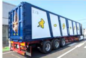
▲トレーラータイフワーキングフロア エコロジーボックス
